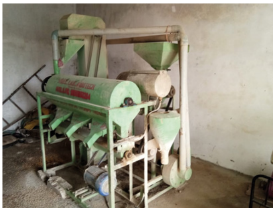
Dal mill unit
